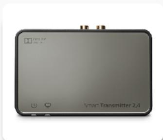
Transmisor Bluetooth para televisión y sistemas de audio. Un dispositivo versátil que conecta televisores y sistemas estéreo con tus audífonos y transmite el audio directamente a tus dispositivos.
